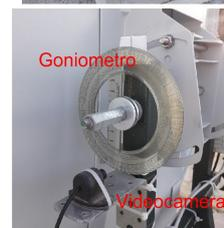
Affinché potessi da remoto conoscere gli angoli di puntamento dell'antenna, sia sul piano verticale che su quello orizzontale, ho applicato su entrambi gli assi di rotazione del supporto due potenziometri lineari che mi ritrovavo e due goniometri acquistati in cartoleria, questi ultimi accoppiati a due piccole, economiche videocamere normalmente utilizzate per la visione in
